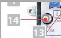
Am Eingang ist eine bidirektionale Messbuchse [14] (siehe Bild links) mit 20 dB Auskoppeldämpfung vorhanden. Hiermit können Sie:
