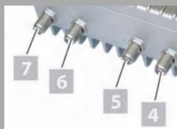
Die richtgekoppelte Messbuchse [5] (siehe Bild links, Mitte) hat ebenfalls 20 dB Auskoppeldämpfung. Mit dieser können Sie:
